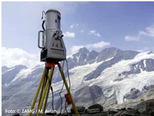
Foto: © ZAMG / M. Avian Mit einem Laserscanner werden im Gebiet des Großglockners die Steinschlag- und Felssturzakktivität im Bereich des Mittleren und Hohen Burgstalls erfasst.
