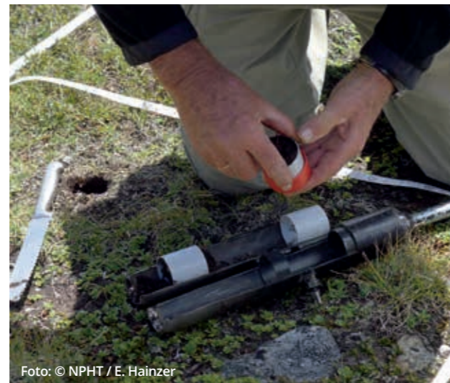
Entnahme einer Bodenprobe durch Erwin Meyer, für die spätere Bestimmung der Milbenindividuen und Springschwänze im Bodenlabor der Universität Innsbruck. Beprobung mittels modifiziertem O' Connor Splitcorer (Ø 5 cm) und Unterteilung in Vertikalfractionen von 0-5, 5-10 und 10-15 cm Tiefe.
